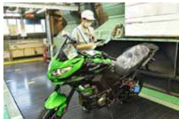
完成車検査場では、検査員がiPadを使って各車両の検査項目をチェック。部品の取り付け位置も画像で確認できるため、作業効率が格段にアップしている
